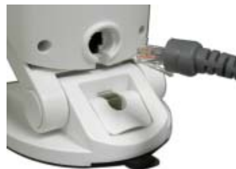
図6：インターフェース・ケーブル接続
