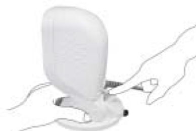
図2：吸盤の位置を合わせて片手でしっかりと保持します。
