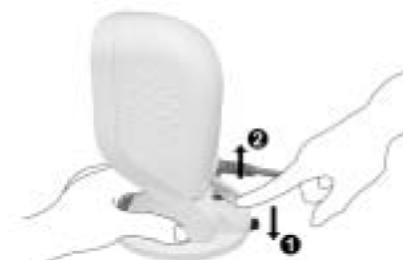
図3：レバーを押し下げて本体を固定します。
